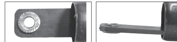
4. Vissez maintenant la barre de torsion à l'intérieur de la partie arrière du waveboard, aussi fermement que possible.
