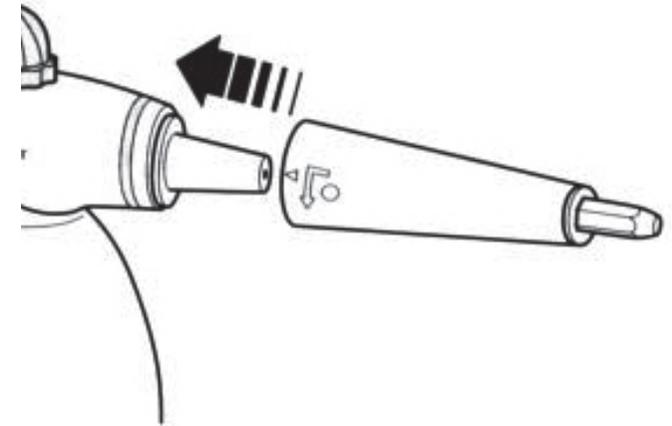
Setzen Sie den Sprühaufsatz gemäß der Abbildung auf den Bajonettverschluss des Geräts auf und drücken Sie ihn nach hinten, bis er einrastet. Anschließend drehen Sie den Aufsatz solange im Uhrzeigersinn, bis er fest sitzt. Um den Aufsatz zu entfernen, verfahren Sie in umgekehrter Reihenfolge.
