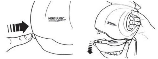
2. Entfernen Sie den Verschluss und füllen Sie den Tank mit dem Mittel Ihrer Wahl. Setzen Sie den Tank anschließend wieder in das Gerät ein.
