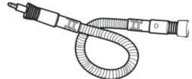
Setzen Sie den Verlängerungsschlauch gemäß den Angaben in a) auf das Gerät auf. Er wird empfohlen, wenn Sie schwer erreichbare Stellen reinigen wollen. Sie können alle mitgelieferten Aufsätze sowohl direkt an das Gerät als auch an die Verlängerung anschließen.
