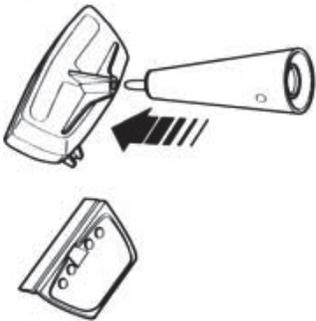
Dieser Aufsatz wird in Kombination mit dem Aufsatz für Polstermöbel verwendet. Haken Sie die beiden Scharniere am Polstermöbelaufsatz in die Aufhänger des Fensterabziehers und drücken Sie den Polstermöbelaufsatz nach unten, bis er hörbar einrastet. Um ihn zu entfernen, ziehen Sie einfach den Riegel am Fensterabzieher zur Seite.
