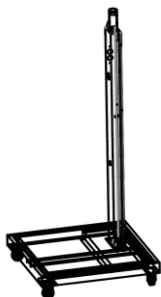
Barre du ventilateur fixée
