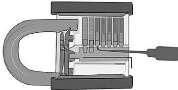
6. Wenn alle Stifte nach oben geschoben sind, drehen Sie den Spanner, um den Zylinder zu drehen und das Schloss zu öffnen.
