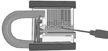
5. Wiederholen Sie die Schritte von Punkt 4 für alle weiteren Stifte. Halten Sie dabei die Drehung des Zylinders aufrecht, um zu verhindern, dass die Stifte wieder in den Zylinder fallen. Ggf. müssen Sie für einzelne Stifte die Drehung leicht erhöhen oder reduzieren.
