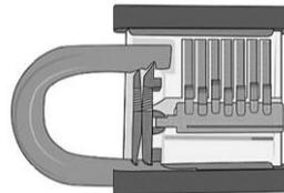
2. Stellen Sie fest, in welche Richtung Sie den Zylinder drehen müssen, um das Schloss zu öffnen. Versuchen Sie es erst im und dann gegen den Uhrzeigersinn. Bei korrekter Richtung, dreht sich der Zylinder ein kleines Stück mit. Der Endpunkt der Drehung ist weicher als in der falschen Richtung. Manche Schlösser öffnen sich in beide Richtungen.
