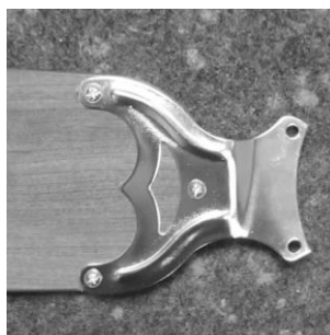
Schraube – Einlegscheibe – Verbindungsplatte – Rotorblatt
