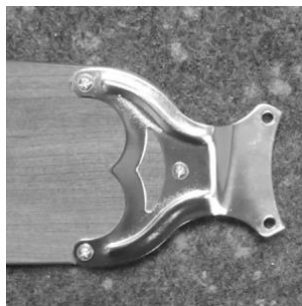
Schraube – Einlegscheibe – Verbindungsplatte – Rotorblatt
