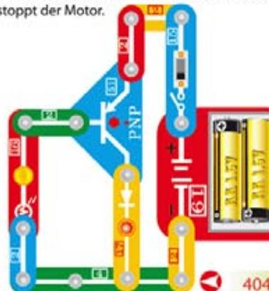
404. LED leuchtet, wenn sie dem Licht ausgesetzt wird 2
