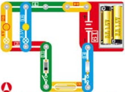
67. Drei Schalter in Reihe steuern zwei parallele Lampen
