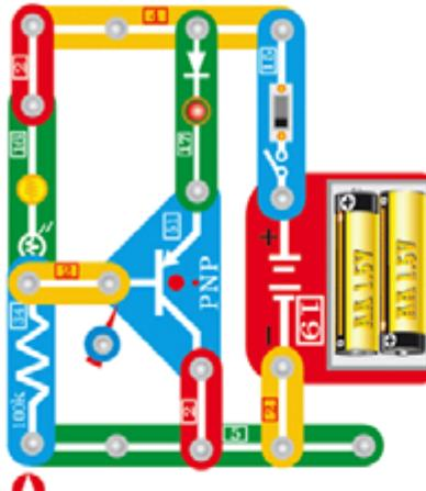
406. LED leuchtet, wenn sie nicht dem Licht ausgesetzt wird 2
