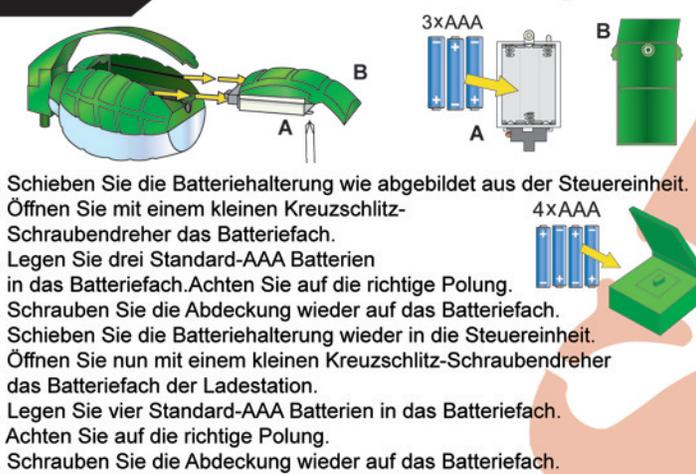
1. Schieben Sie die Batteriehalterung wie abgebildet aus der Steuereinheit.
