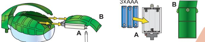
1. Schieben Sie die Batteriehalterung wie abgebildet aus der Steuereinheit.
