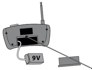
Ouvrez le compartiment à l'arrière de la télécommande en la dévissant. Retirez le couvercle et insérez une pile 9V. Refermez le compartiment.
