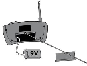
Öffnen Sie das Batteriefach an der Fernsteuerung. Lösen Sie die Schraube am Batteriefach mit einem kleinen Kreuzschlitz-Schraubendreher und nehmen Sie dann die Klappe ab. Schließen Sie an den Anschluss im Batteriefach einen 9V-Block an und legen Sie diesen dann in das Batteriefach. Schließen Sie das Batteriefach wieder.
