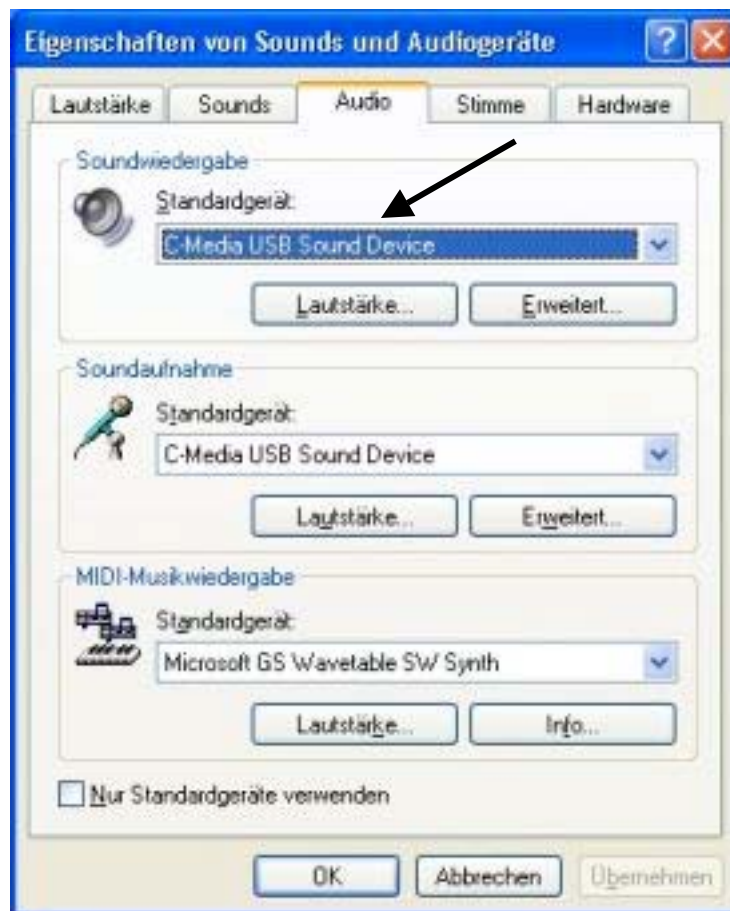
Abbildung 2: An dieser Stelle muss der C-Media-Audiotreiber nach der Installation als Standardtreiber eingestellt sein.
