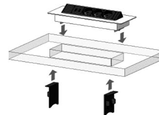
4. Setzen Sie die Gegenhalterung von unten auf die Halterungsschienen der Steckdosenleiste ein, bis sie festen Kontakt mit der Tischplatte haben.
