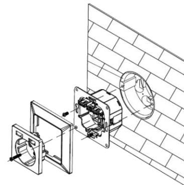
1. Entfernen Sie die Blende, indem Sie die Steckdose mit 2-fach-USB-Netzteil nach hinten aus der Halterung drücken.
