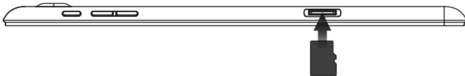
Setzen Sie eine microSD-Speicherkarte (max. 64 GB) in den Kartenslot wie auf der Zeichnung auf dem Gerät angegeben. Schieben Sie nicht zu fest und wenden Sie keine Gewalt an. Ein Federwiderstand muss überwunden werden. Die Speicherkarte ist richtig eingesetzt, wenn sie leicht einrastet und nicht von selbst wieder herausgleitet. Um die Speicherkarte zu entnehmen, drücken Sie sie ein Stück in das Gerät, bis der Federwiderstand sich löst, und ziehen Sie sie anschließend heraus.
