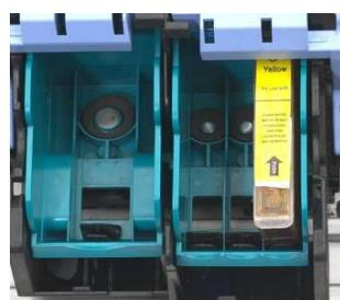
**7)** Patrone am vorderen Ende leicht **nach unten drücken**, bis sie in den Adapter-Clip **hörbar einrastet** („Click!“). Der Clip muss bereits zuvor am Drucker befestigt sein (siehe Schritt 1 - 4). In gleicher Weise auch die anderen Patronen einsetzen.
