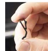
**2)** Den Clip im Vorderteil des Druckkopfes einsetzen. Die Nase unten passt genau in die wappenförmige ca. 4 mm große Öffnung vorne **im Boden des Druckkopfs**.
