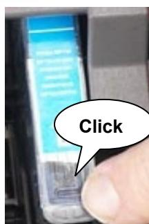
**8)** Zum Auswechseln der leeren Patrone einfach am Adapter-Clip ziehen. **Der Clip kann im Drucker verbleiben**. Nur bei Verwendung von original Canon-Patronen muss der Clip wieder entnommen werden. Zum Entfernen einfach die 2 Flügel des Clips etwas zusammendrücken.
