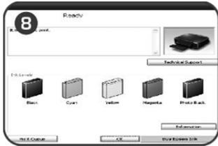
6. Der Drucker zeigt die Meldung „Die Tintenpatrone muss bald ausgetauscht werden“, wenn der Tintenstand in der Patrone niedrig ist. Anschließend wird der Hinweis auf den Tintenstand „I“ angezeigt.
