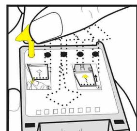
3. Wenn die Patrone mehrere Löcher mit Membranen hat, stellen Sie sicher, dass Sie alle Membranen lochen.
