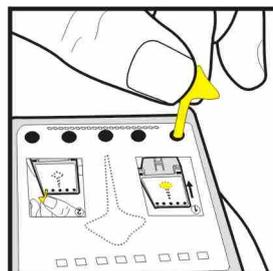
4. Stechen Sie mit der Nadel ein etwa 7mm tiefes Loch in die Membranen unter der Abdeckung, wie in der Skizze gezeigt.
