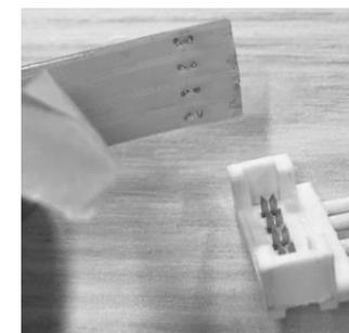
6. Placez les points de contact (situés sur le dessous de la bande LED) contre la fiche de contact du câble de connexion. Appuyez fermement.
