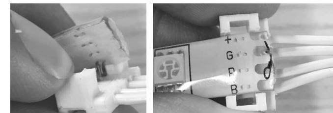
7. Setzen Sie die Klemme passend auf. Drücken Sie sie an, bis beide Seiten eingerastet sind.
