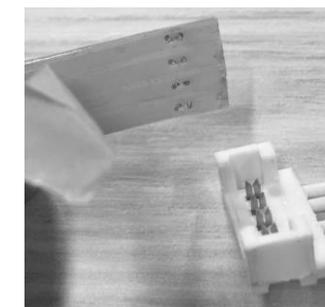
6. Legen Sie die Kontaktpunkte auf der Unterseite des LED-Streifens passend auf die Kontaktstecker Ihres Verbindungs-Kabels. Drücken Sie sie fest an.
