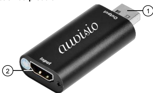
1. Connecteur USB 2. Port HDMI
