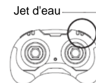
Appuyez une fois sur le bouton pour activer le jet d'eau. Appuyez à nouveau sur le bouton pour arrêter le jet d'eau.
